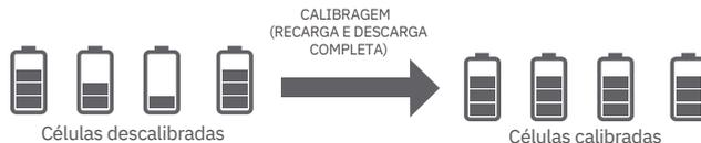
Este processo de recarga e descarga completa e ininterrupta deve ser repetido 3 vezes na primeira utilização (3 ciclos) e repetido ao menos uma vez por mês (um ciclo). Evite descarregar a bateria por completo constantemente. A cada vez que a bateria é descarregada por completo, um ciclo é contado, diminuindo sua vida útil e autonomia. Repita o processo a cada 30 ciclos.
